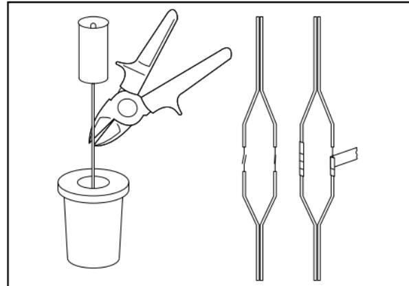
Bild 3 & 4, Dampfentwickler austauschen
