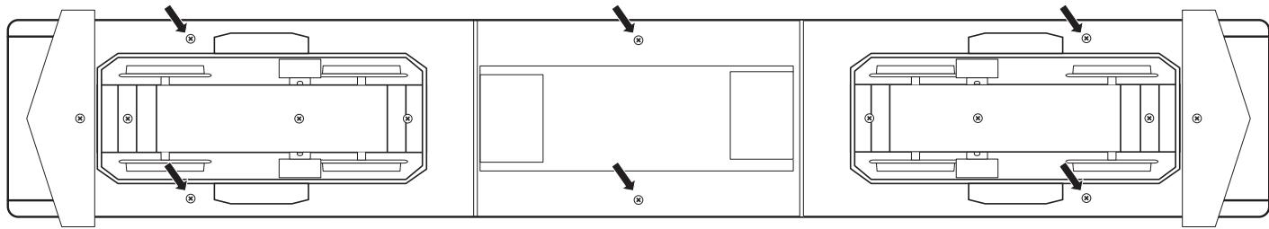
Bild 4, zum Öffnen der Lok die markierten Schrauben entfernen
