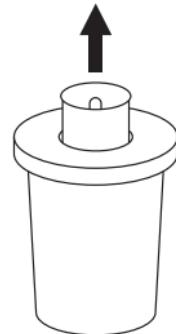
Bild 4 & 5, Dampfentwickler austauschen
