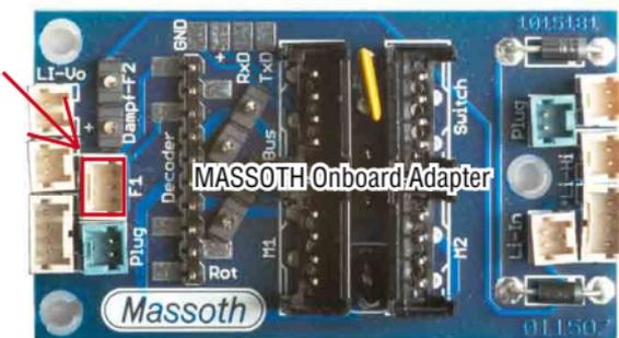
Abbildung 3: Anschluss des Entkupplers an Decoder und Schnittstellenplatten
