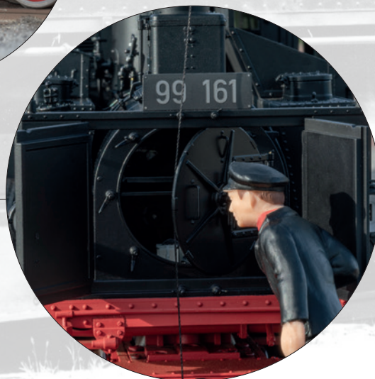
En net zoals bij het voorbeeld moet ook bij het model eerst de bekleding worden geopend om toegang tot de rookkastdeur te krijgen
