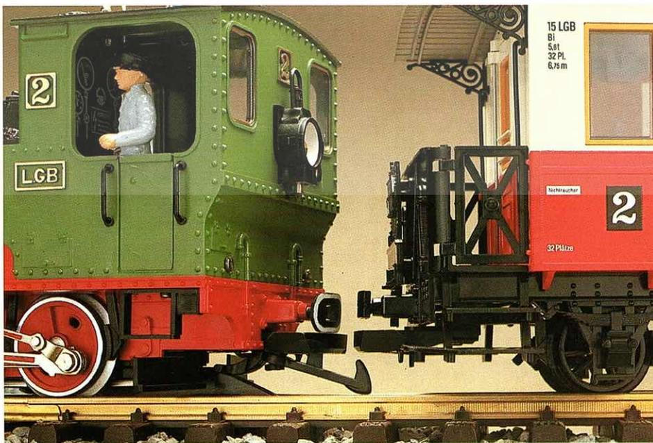
Bild 4 Dauerentkupper im Einsatz – auch im Bogengleis.
