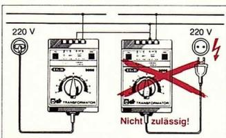
**Abbildung 6:** Werden zwei oder mehr Trafos gleichzeitig betrieben, so ist unbedingt darauf zu achten, daß die Netzstecker von allen Trafos in Steckdosen eingeführt sind. Bei nicht in Steckdosen eingeführte Trafos kann die volle Netzspannung am Netzkabelstecker anliegen! Lebensgefahr!
