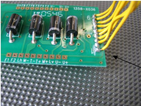
2. Kabel mit den Schnittstellen am Blindstecker oder einer Stiftleiste 2,5 mm verlöten.
