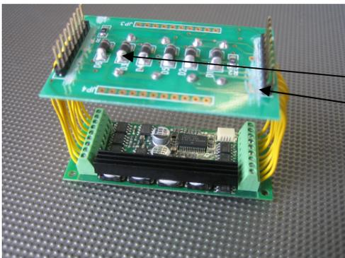
Bei Nutzung des Blindsteckers müssen die Verbindungen zum Schaltkreis durchtrennt werden. Bei Nutzung von zwei Stiftleisten entfällt dieser Vorgang.
